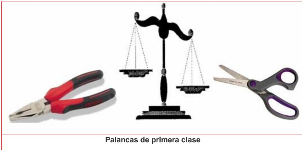
Algo que desde ya debe destacarse es que al accionar una palanca se producirá un movimiento rotatorio respecto al fulcro, que en ese caso sería el eje de rotación.
